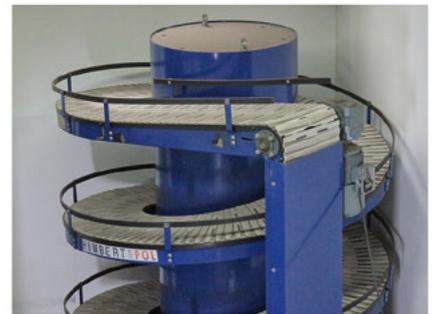
Überlappende Transportplatten auch in den Bahnkurven sorgen für den sicheren Transport des Stückgutes sowie für einen verschleiß- und geräuscharmen Dauerbetrieb.
