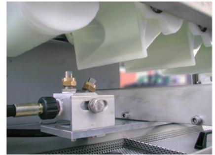
Le nettoyage des godets peut être optimisé par l'installation ou le rééquipement d'élevateurs HUMBERT & POL en activité, puis par l'orientation des buses sur les rampes, la programmation des temps de cycle et le réglage de la pression d'air ou d'eau.
